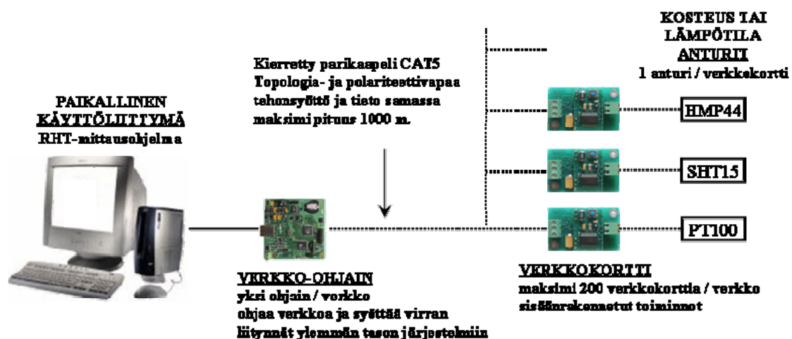
Periaate RHT-mittausjärjestelmän rakenteesta
