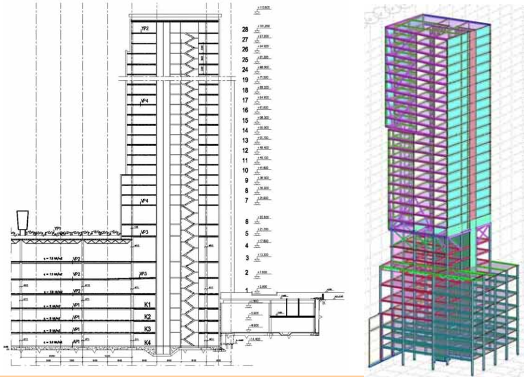
Runko: Kallioanturat, Liittopilarit, WQ-palkit, Ontelolaatat 320...500. Paikallavalu (as.)
