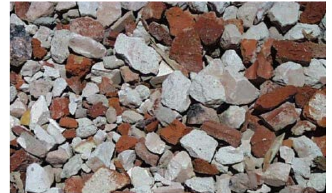
Tiilimurske (kuva: Tero Elo 1999)
